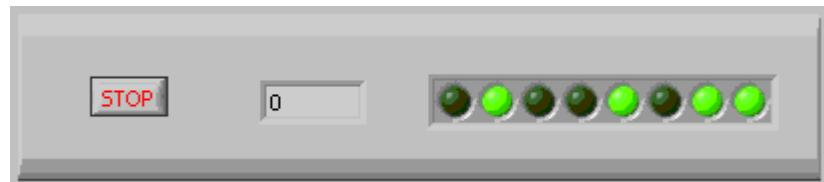
In vederea rularii repetate, pana la apasarea butonului "Stop" se va utiliza deci inca o structura repetitiva de tipul "While Loop".
