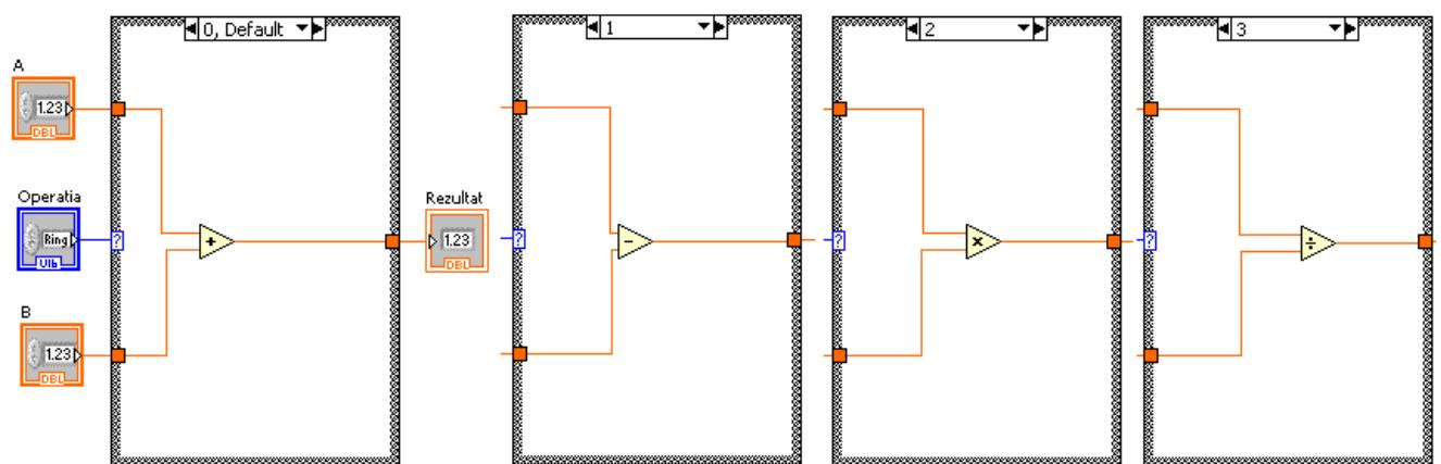
Vom utiliza in continuare structurile case pentru a afisa diverse combinatii de leduri aprinse selectate de la un control numeric [if v1 v3](#)
