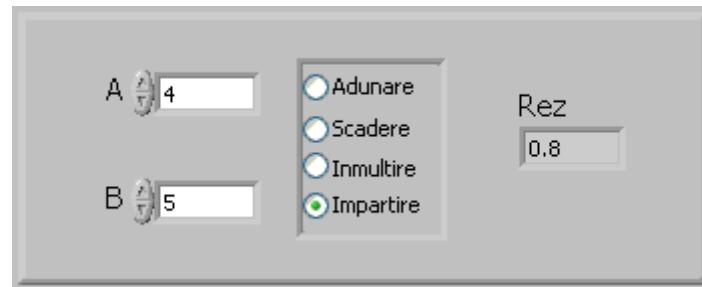
Pentru diagrama bloc s-a folosit o structura "Case" cu patru variante selectate prin intrarea de selectie de tip alfanumeric. Structura "Case" accepta fara nici un fel de setare intrare de selectie booleana, numerică sau alfanumerică.
