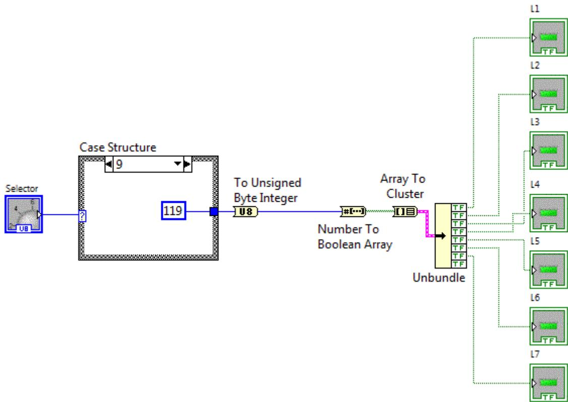
Structura "Case" ne ofera un numar int a carui reprezentare binara o reprezinta combinatia de segmente care trebuie activate pentru a forma afisarea corespunzatoare pe 7 segmente. Numarul int se converteste in Uint dupa care e convertit intr-un vector binar. In urma conversiei "Array to Cluster" obtinem o structura de date pe care daca o despachetam cu functia "Unbundle" obtinem in sfarsit 7 iesiri binare necesare comandarii celor 7 segmente.
