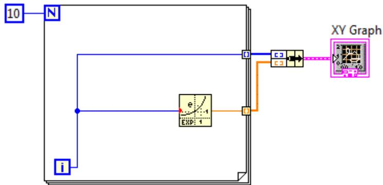
Structura de date necesara controlului grafic XY Graph este realizata utilizand un cluster folosind "Bundel Function" pe care o gasim in Function-->Programming-->Claster, Class & Variant-->Bundle.
